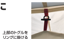
ボトム部のフックをコーナーのループ及びリングに掛ける (ベグダウン部への固定)
